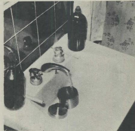
8. Abre el tanque y haz el lavado final con agua corriente.
